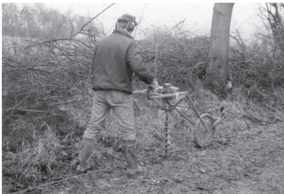
Figur 5.11. »Pflanfuchs« jordbor til borede stolpehuller har en høj præstation. (Foto: T. Wiberg, 1996).
