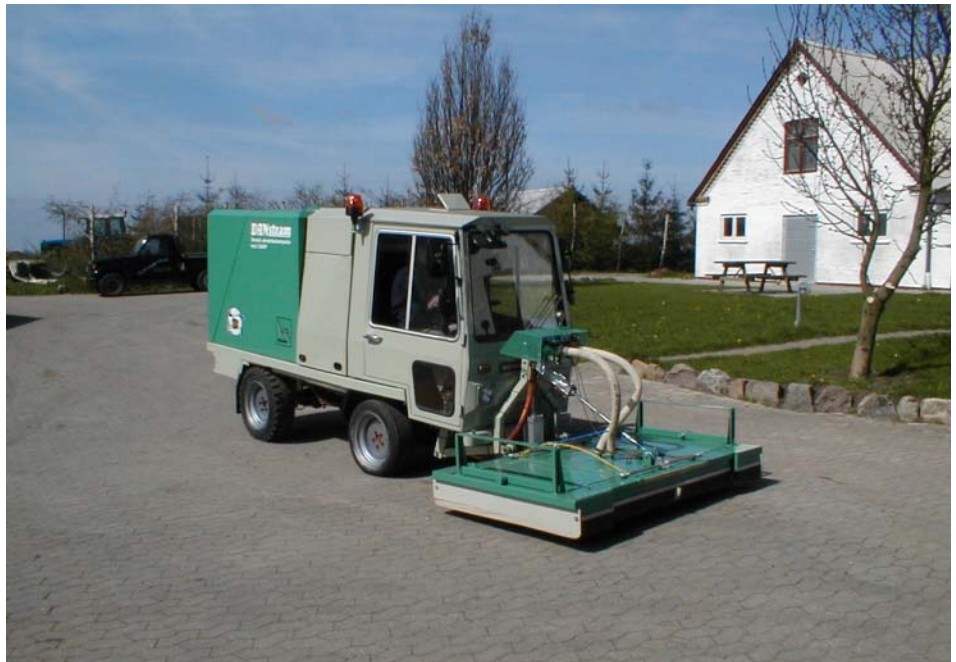
Figur 21. Dampudstyret opbygget på chassiset fra en suge- fejmaskine giver dampmetoden en stor fleksibilitet og manøvredegtighed. Denne maskine er den mest udviklede, der findes til pesticidfri ukrudtsbekæmpelse.
