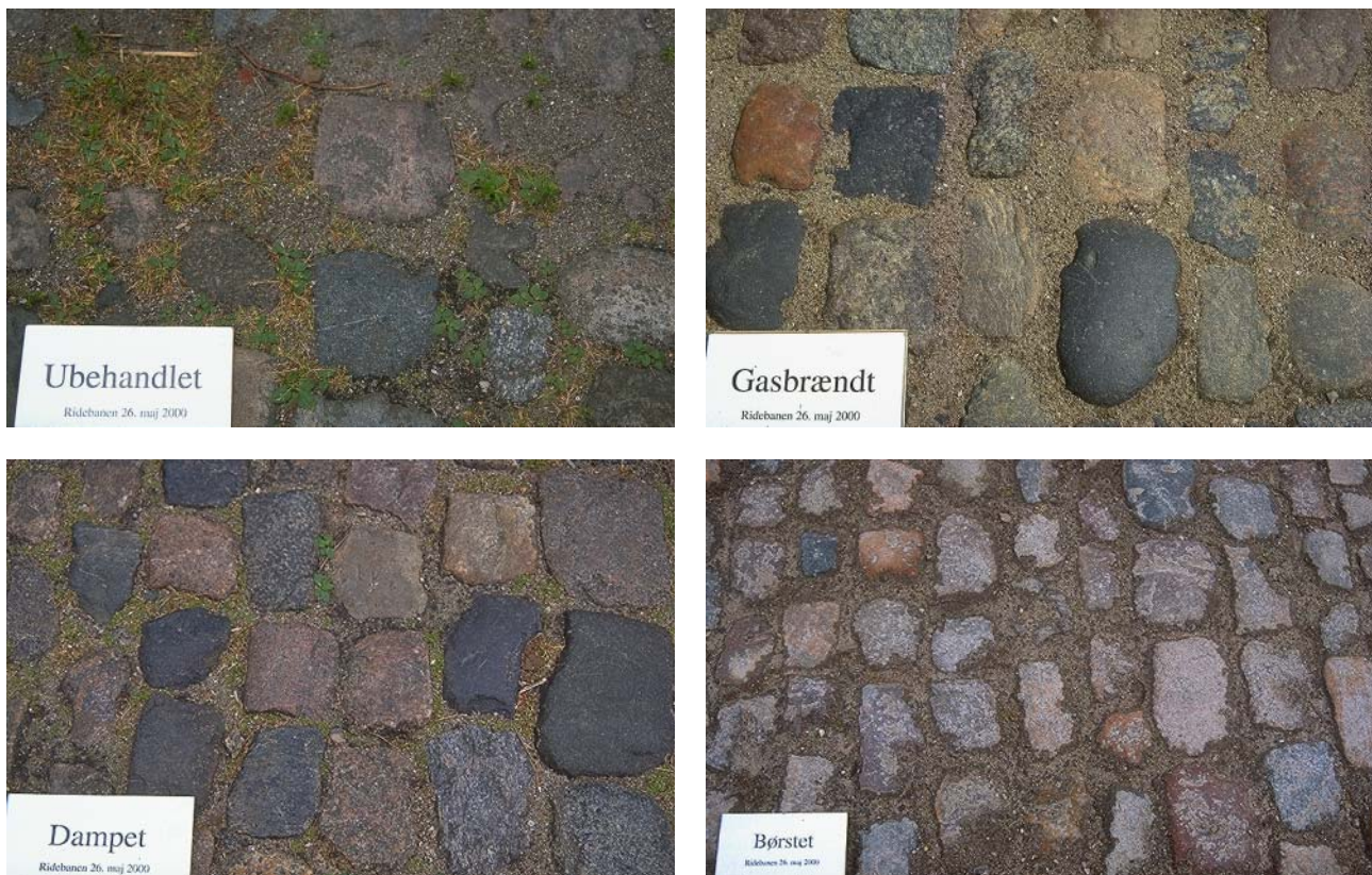
Figur 5. Billedserie der viser effekten af de udførte behandlinger d. 26. maj. Flammebehandling er senest udført d. 22. maj, dampbehandling d. 16. maj og børstning d. 23. maj.
